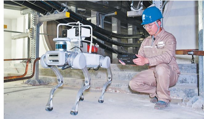
四足电缆巡检机器人在隧道内巡检。(国网福州供电公司供图)
