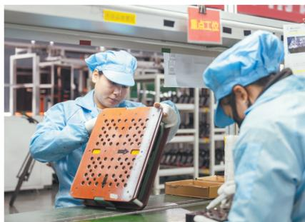
云众动力生产线上,工人在组装锂离子电池组。
