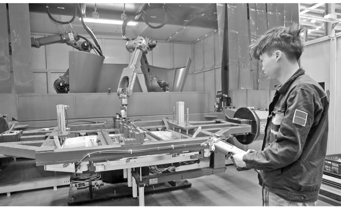
位于闽侯的祥鑫铝业车间,机器人与工人配合进行焊接作业。本报记者 包华摄
