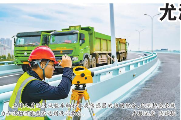
工作人员通过试验车辆和各类传感器的协同配合,检测桥梁承载力和结构性能是否达到设计要求。 本报记者 陈暖摄
