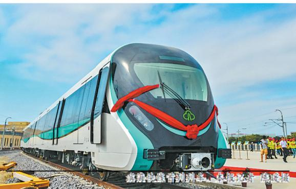
技术负责人王洋介绍,列车全列四辆编组车长95.8米,车体最大车宽3.09米,车体最大高度3.54米,单节车基本车长22米。
