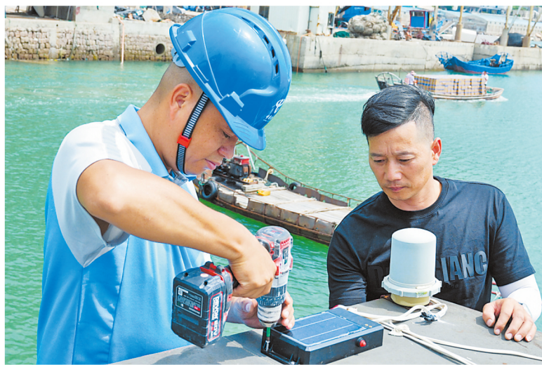
电信工作人员为渔船安装卫星定位设备。
