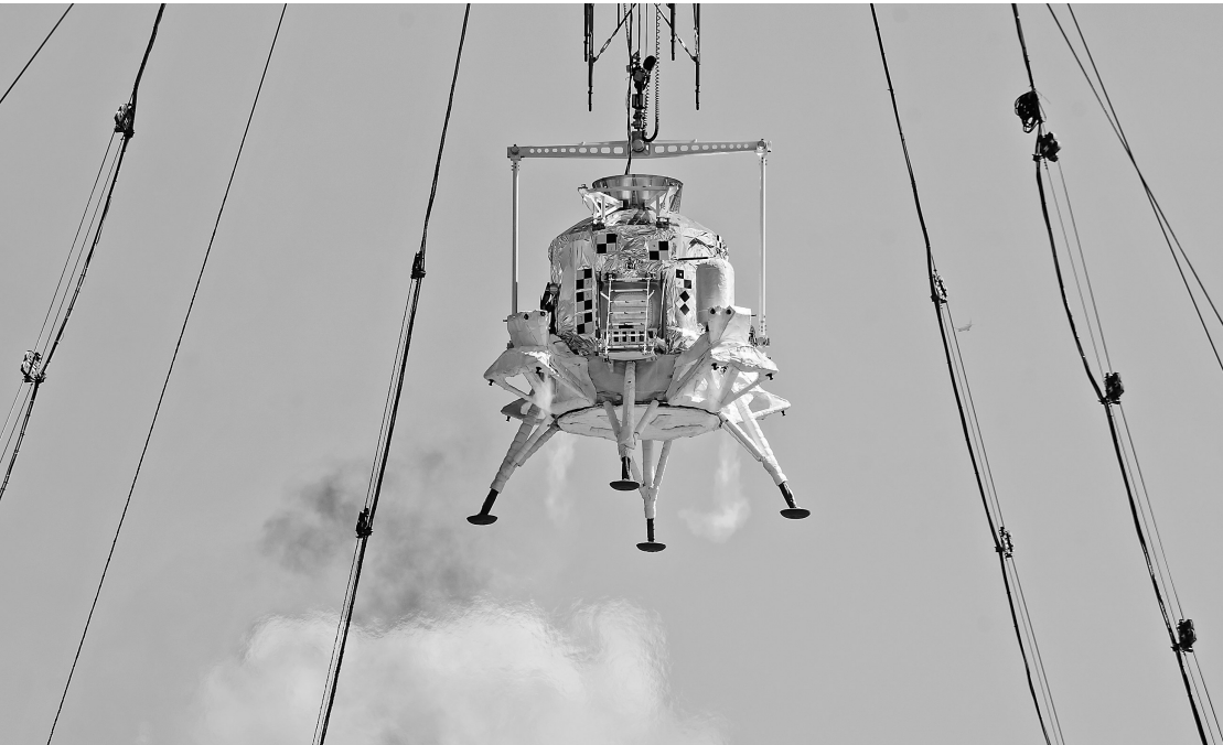
揽月月面着陆器在地外天体着陆试验场进行测试。新华社发
