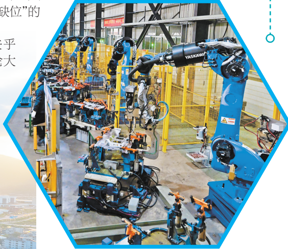
福强公司技改后,电焊工作全部由机械手臂完成,有效提升了生产效率。 本报记者 郑邦摄
