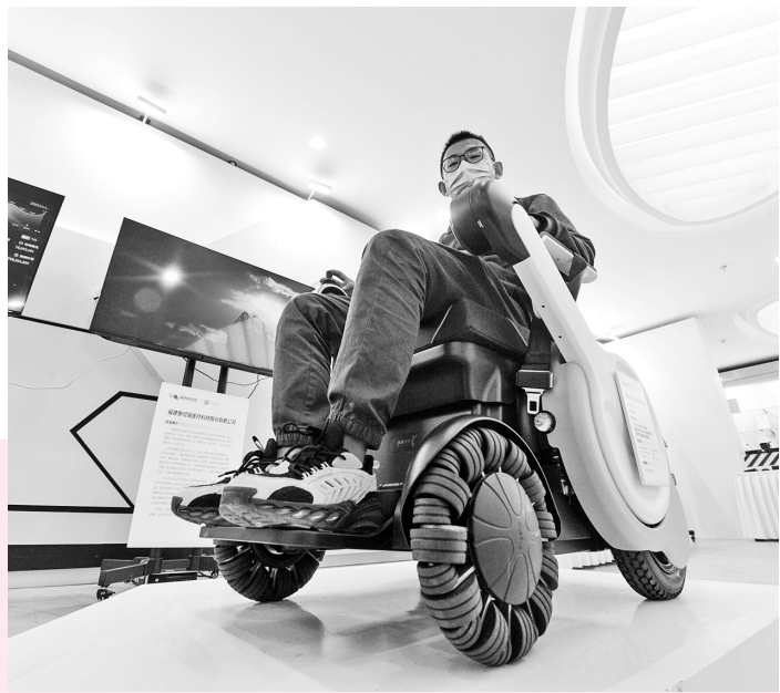
施可瑞“椅夫车”的前轮采用了新型全向轮,使用起来更加灵活便利。 本报记者 池远摄
